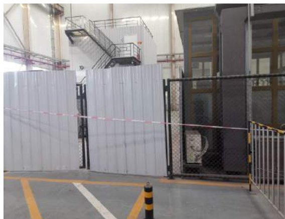
探伤作业现场警戒线
