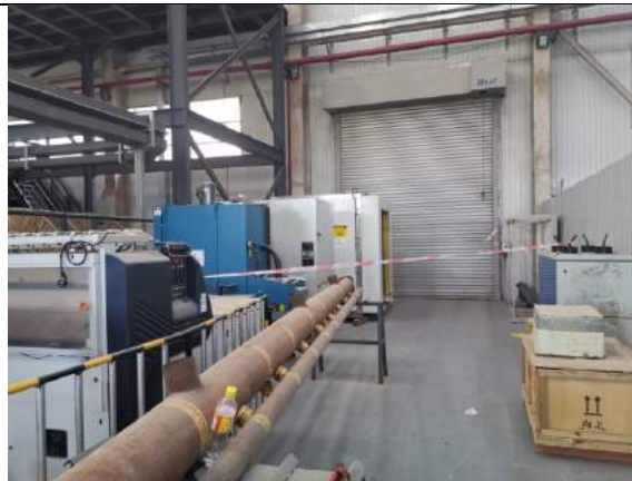
探伤作业现场警戒线
